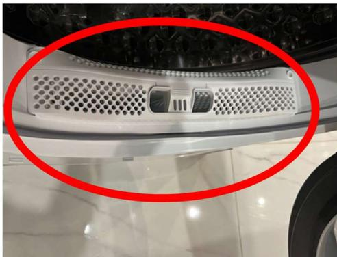
1. ドアを開き、下側にある糸くずフィルターを引き上げて取り外します。
