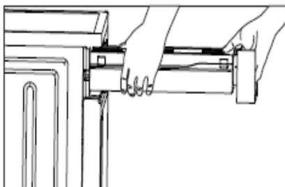
1. 乾燥機前面、左上にある排水ウォーターコンテナを手前に引出し、取り外します。
