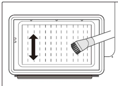
3. ロック解除後、中央の取っ手を使用して取外し、奥にある熱交換器フィルターの表面を約半年に一度の頻度で「掃除機のブラシ付きのノズル」などで清掃してください。ノズルがない場合、不要な歯ブラシなどでホコリを落とし、掃除機で吸い取ってお手入れしてください。
