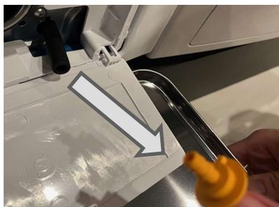
4. オレンジ色のキャップを外し、トレイに水抜きをします。水が抜け切りましたら、キャップを付け、元に戻します。
