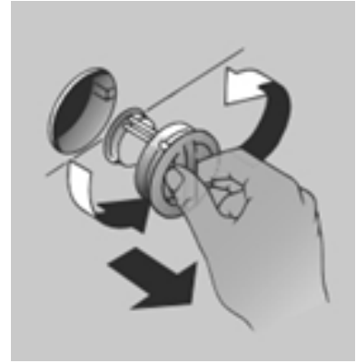
フィルターを反時計回りに ゆっくり回し取り外してください
