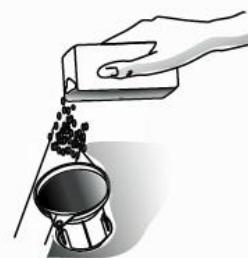
補充が必要な場合、コントロールパネルのソルト補充ランプを確認します。
