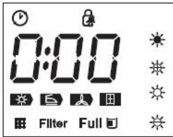
1. プログラムが終了するとドラムの作動が停止し、ディスプレイに「0:00」が表示され、最終進行表示が点滅します。乾燥機は、お客様が 1 分以内に洗濯物を取り出さないと「しわ防止」機能を開始します。「オン/オフ」ボタンを押して電源を切り、可能であればプラグを抜いてください。
