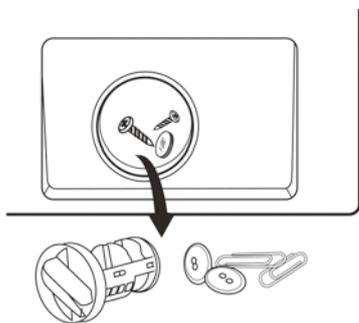
**4** 異物を取り除いたら各パーツを元通りに取り付けてください。最後にフィルターカバーがしっかりと締められていることを確認してください。
