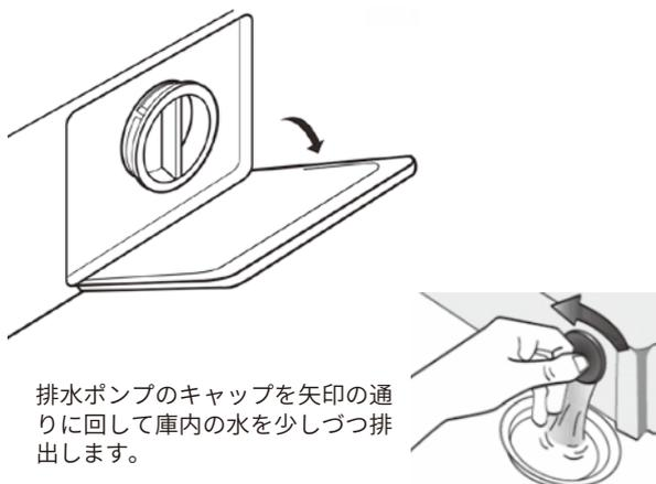
**2** 反時計回りに回しフィルターを取り外します。
