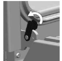
2.両方のラッチを回して、ヒンジをブロックします。
