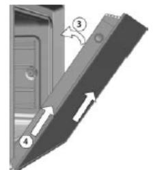
4.両手でドアの両側を持ち、ヒンジが完全に外れるまでオーブンドアを持ち上げて引き抜きます。
