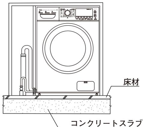
※床材とコンクリートスラブは隙間なく密着していることを確認してください。
